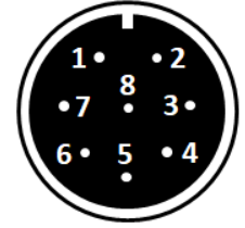
M12 / 8 Pin dişi soket (kablo takılan soketin karşıdan görünümü)
